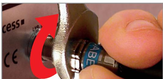
■ Poursuivez le vissage au moyen d'une clé plate de 11mm, cela aura pour effet de serrer la fiche sur le câble.
