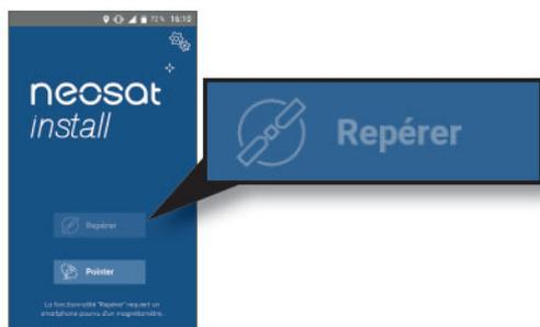
Si le bouton **Repérer** de l'appli *neosat install* est grisé (inactif), ceci est probablement dû à l'absence des composants électroniques que sont l'inclinomètre et/ou la boussole numérique au sein de votre smartphone.
