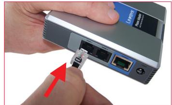
**5** Munissez-vous du câble Ethernet RJ-45 fourni par NordNet et branchez l'une de ses extrémités sur le port « INTERNET » du boîtier de communication VoIP.
