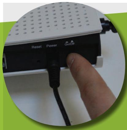
1. Une fois sous tension, la Wibox effectue une mise à jour automatique, les voyants clignotent durant 3 à 5 minutes, jusqu'à se stabiliser.
