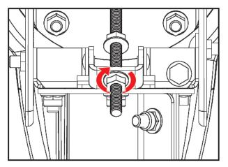
■ Tournez la vis de réglage fin de l'élévation dans le sens des aiguilles d'une montre jusqu'à ce que le SQF Actuel tombe de nouveau à un niveau très bas.
