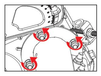
■ Desserrez légèrement les trois écrous de verrouillage du réglage de l'azimut situés sur la face inférieure du mécanisme, comme illustré sur la figure ci-contre, afin de rendre lâches leurs boulons respectifs.
