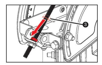
■ Repositionnez en butée l'écrou de verrouillage n°3 de la vis de réglage de l'élévation.
