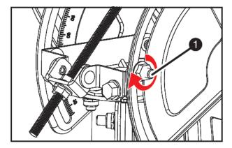
■ Serrez à leur maximum les écrous de verrouillage n°1 et n°2.
