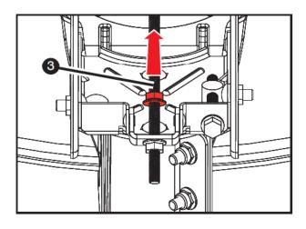
■ Dévissez l'écrou de verrouillage n°3 à la main.
