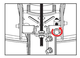
■ Tournez à présent la vis de réglage fin de l'azimut dans le sens inverse des aiguilles d'une montre. La valeur du SQF Actuel va peu à peu augmenter pour égaler, sinon dépasser, la valeur de SQF Max.
