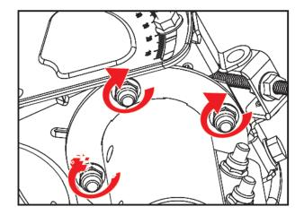
Serrez à leur maximum les trois écrous de verrouillage du réglage de l'azimut situés sur la face inférieure du mécanisme de pointage.
