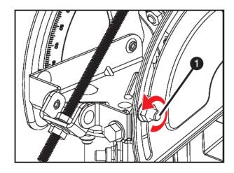
■ Desserrez l'écrou de verrouillage latéral (n°1 ci-contre) situé sur la droite du mécanisme de réglage du pointage afin de rendre le boulon légèrement lâche.
