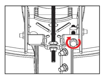
■ Tournez quelque peu la vis de réglage fin de l'azimut dans le sens des aiguilles d'une montre jusqu'à ce que le SQF Actuel tombe à un niveau très bas.
