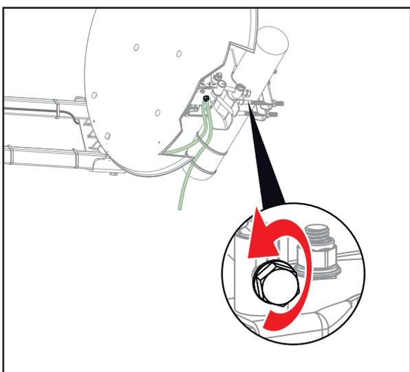
■ Tournez quelque peu la vis de réglage fin de l'azimut dans le sens inverse des aiguilles d'une montre jusqu'à obtenir un son grave et discontinu.
