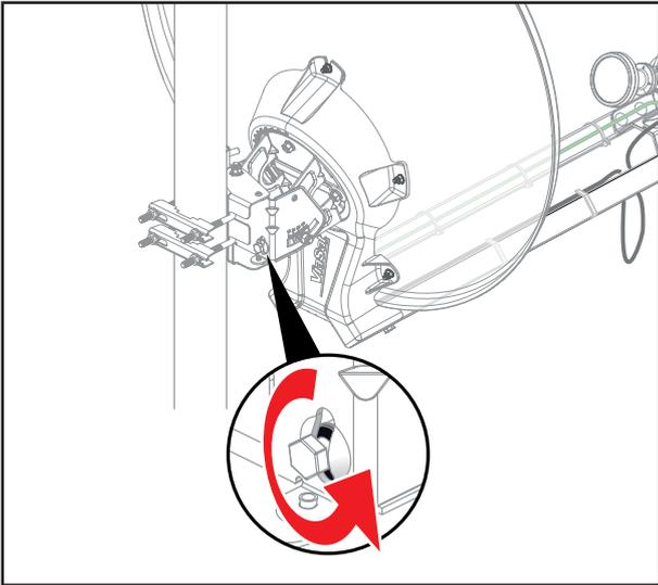
■ Tournez quelque peu la vis de réglage fin de l'élévation dans le sens inverse des aiguilles d'une montre jusqu'à obtenir un son grave et discontinu.
