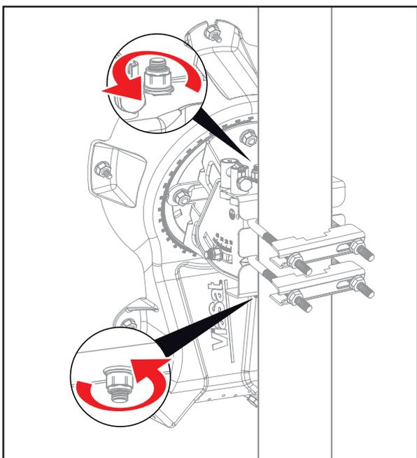
■ Desserrez les écrous supérieur et inférieur sur le mécanisme de pointage afin que leurs boulons respectifs deviennent lâches.
