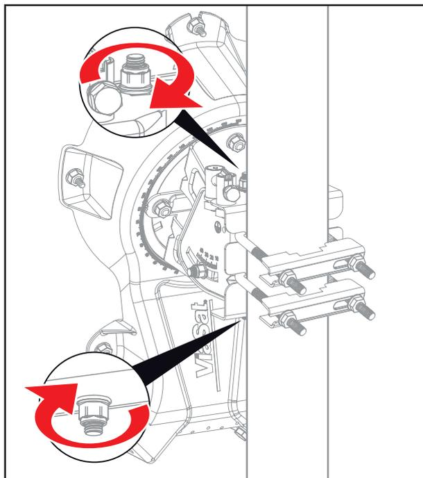
■ Serrez à leur maximum les écrous supérieur et inférieur sur le mécanisme de pointage.
