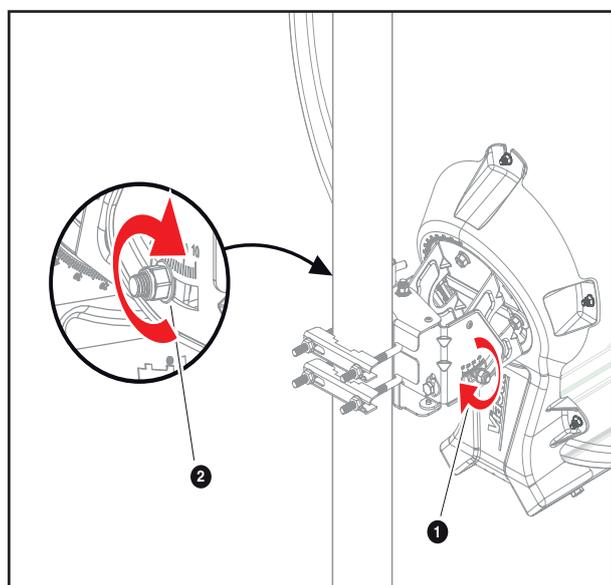
■ Serrez à leur maximum les écrous latéraux n°1 et 2 sur le mécanisme de pointage.
