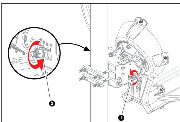
■ Desserrez les écrous latéraux n°1 et 2 sur le mécanisme de pointage afin que leurs boulons respectifs deviennent lâches.
