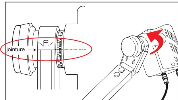
■ Comme illustré ci-contre, faites correspondre la jointure des deux pièces composant la patte de fixation et les indications d'angles gravées sur la tête avec la valeur de « polarisation » trouvée en page 2 du présent guide.
