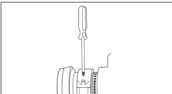
■ Resserrez fermement les vis d'assemblage de la patte de fixation **en faisant attention à ne surtout pas modifier le réglage auquel vous venez de procéder.**
