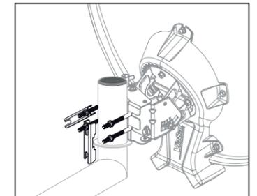
Fixation de la parabole sur le mât
