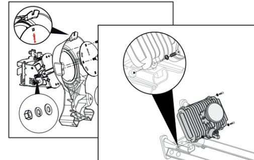
Assemblage des différents éléments composant la parabole
