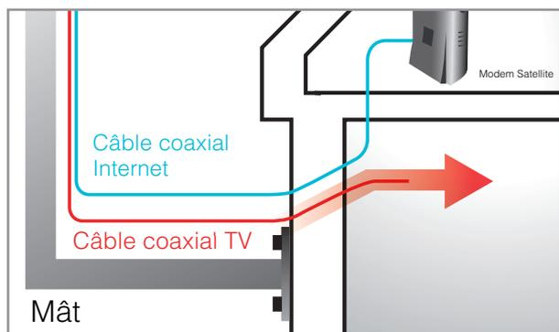
■ A l'endroit qui vous convient le mieux, et si vous ne disposez pas d'une gaine pré-existante, percez le mur extérieur de votre habitation à l'aide de la mèche béton afin de faire passer le câble coaxial dédié à la réception TV, de l'antenne parabolique à la pièce dans laquelle vous souhaitez installer votre décodeur TV.
