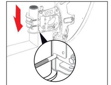
Fixation de la parabole sur le mât
