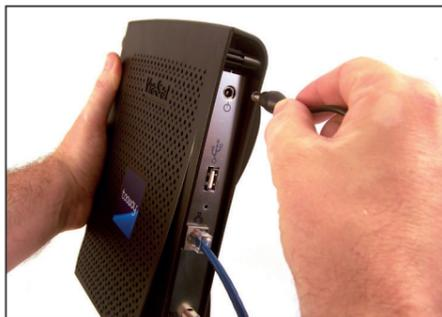
Installation du modem et branchement des câbles
