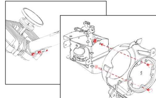
Assemblage des différents éléments composant la parabole
