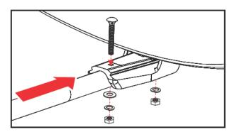
■ Si vous l'aviez démonté de l'antenne parabolique, réinstallez maintenant le plus délicatement possible le bras de support sur cette dernière.
