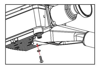
■ Une fois fait, verrouillez l'assemblage des deux pièces au moyen de la vis cruciforme et de la rondelle dentelée mises de côté à l'étape 2.
