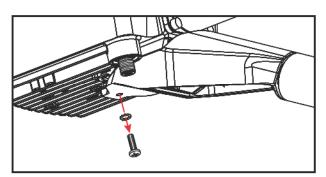
■ Retirez la vis de fixation et la rondelle dentelée maintenant la tête en place sur le bras de support.
